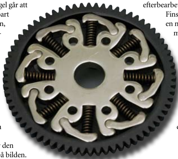
Alla detaljer utom fjädrarna i denna slirkoppling är finstansade och kan monteras direkt utan efterbearbetning.
