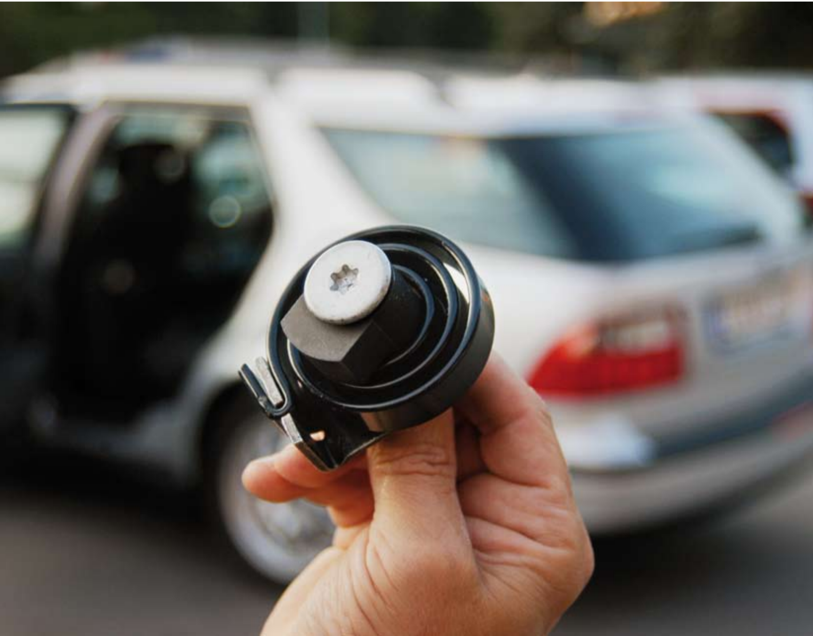
En både enkel och genial lösning: Esma levererar ett fjäderpaket som gör det lättare att fälla upp det tunga ryggstödet i Saab 9-5 kombi.
